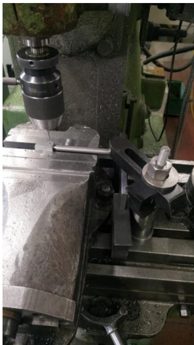
Slika 18: Vrtanje luknje za zatič pri gibljivem vretenu
