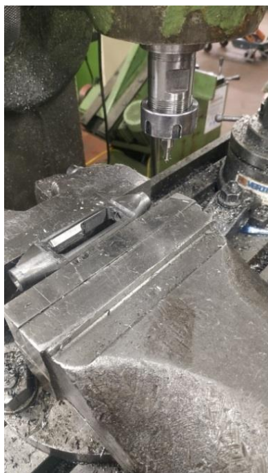
Slika 9: Rezanje vodilnega dela
