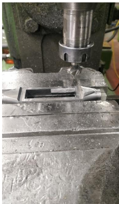
Slika 10: Rezanje robov s 45° grezilom
