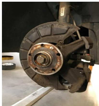
Slika 26: Demontiran zavorni disk in ploščice
