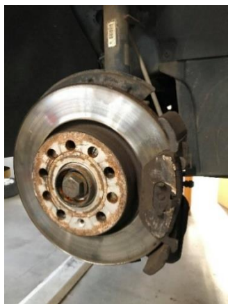
Slika 25: Demontaža zavornega diska ter ploščic
