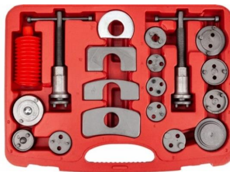
Slika 31: Orodje za stiskanje zavornega bata
