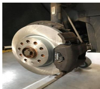
Slika 28: Nameščen nov zavorni disk in ploščice
