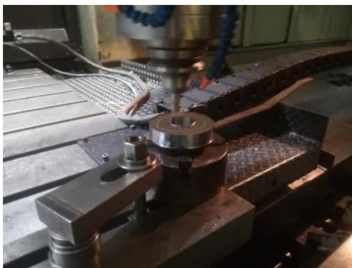
Slika 4: Rezkanje korozije na vrhni plasti
